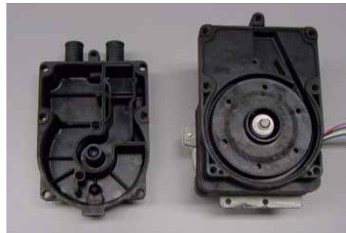
ポンプケーシング内
